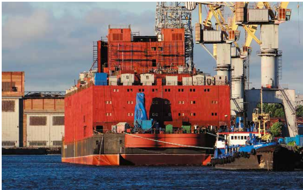
Одно из преимуществ ПАТЭС «Академик Ломоносов» – ее мобильность. Станция может базироваться в любом прибрежном районе и использоваться для выработки как электричества и тепла для населенных пунктов, так и для опреснения морской воды
