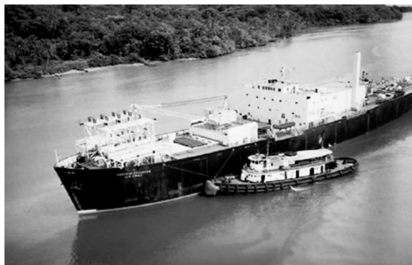
В 1968–1976 гг. вооруженные силы США эксплуатировали плавающую АЭС мощностью 10 МВт на борту баржи Sturgis в Панамском канале. Первые отечественные проекты ПАТЭС начали разрабатываться еще в СССР в 70-е годы прошлого столетия, однако по разным причинам построены не были
