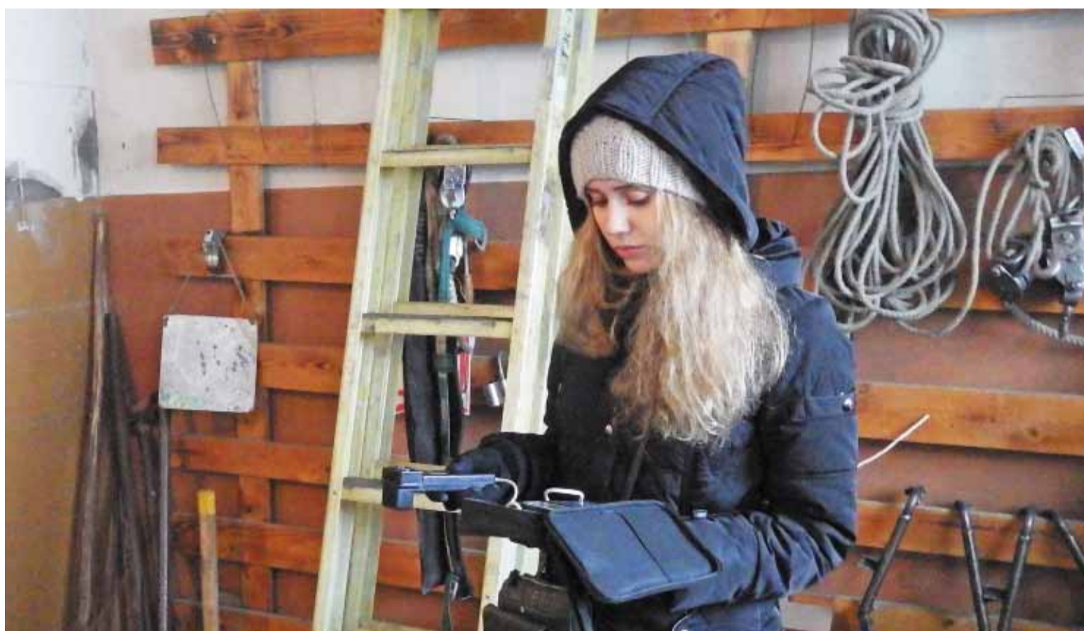
Замер уровня освещенности помещений на участке электрических сетей «Культура» Тихвинского Района электрических сетей филиала ОАО «Ленэнерго» «Тихвинские электрические сети» экспертом предприятия ООО «Си-Эй-Си-Городского центра экспертиз» специальным прибором люксметром
